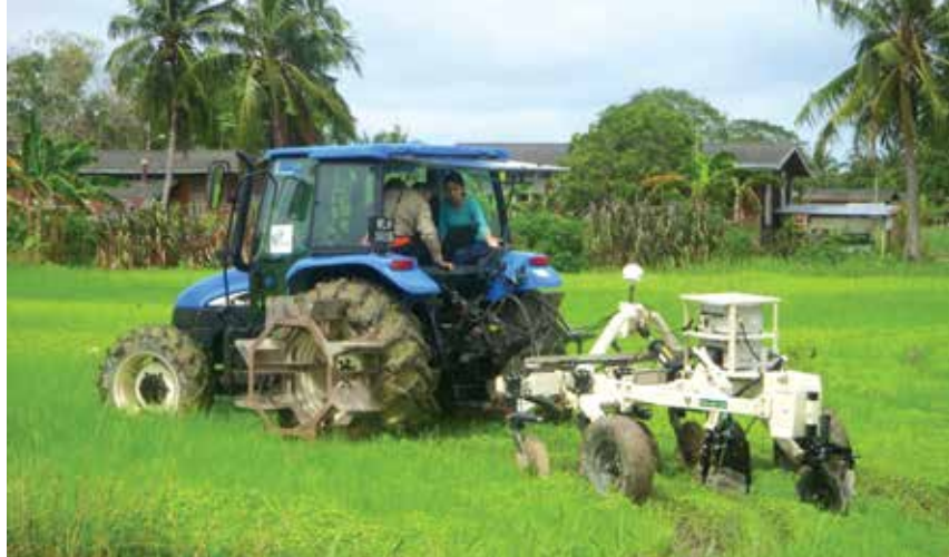
Gambar 2: Sistem pemetaan ciri-ciri tanah menggunakan sensor Soil Electrical Conductivity (ECa)
